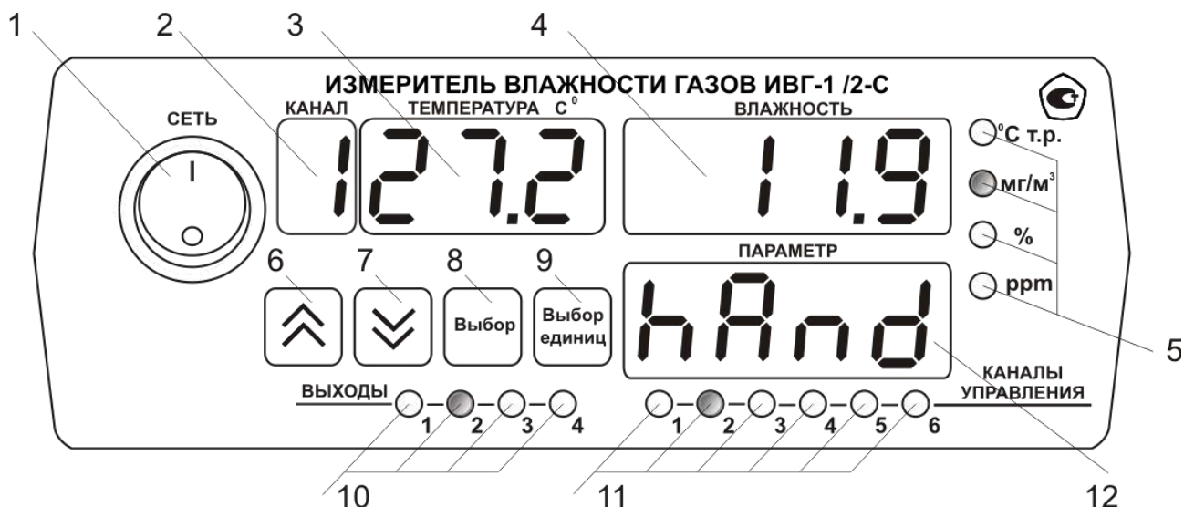
Рисунок 3.1 Вид лицевой панели прибора: ИВГ-1 /1-С-2А, ИВГ-1 /1-С-4Р-2А, ИВГ-1 /2-С-4Р-2А (сверху вниз).
