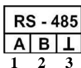
Рисунок 3.7 Вид разъема RS-485
