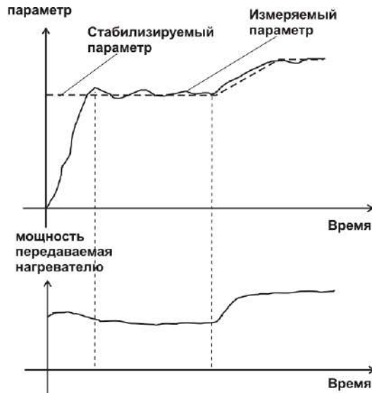
Рисунок 3.14 Стабилизация по ПИД закону
